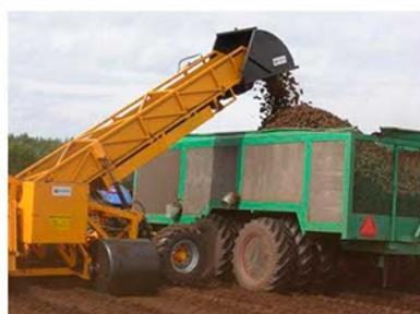
Гидравлическая регулировка высоты загрузки конвейера блок обеспечивает низкую высоту вождения и, при необходимости, высокая погрузочная высота. Даже высокие бортовые прицепы могут быть загружены с легкостью.
