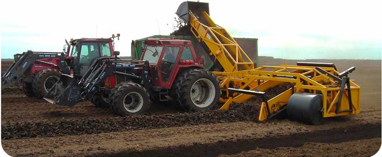
Машина может быть использована для отбора и погрузки хребтов в кювет банка. Машина оснащена электрическим (12 В) полностью автоматическая система смазки. Он также может быть дополнительно оснащен барабан, установленный под палубой сортировочная, который улучшает рельеф вождения свойства, а также транспортные колеса, которые снижаются с помощью гидравлического цилиндра. Эта функция значительно облегчает транспортировку машины с одного рабочего места к другому.
