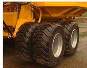
По сравнению с весом машины шины комбайна являются достаточным достаточно большой, снижая тем самым давление на поверхности. Гидромоторы центр доступен в качестве опции устанавливаются в передних колес тележки.
