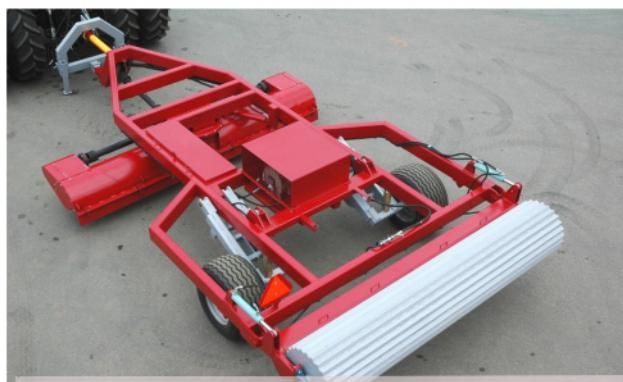
Multi-трейлер ведется работа в этой части области производства торфа перед началом и в процессе производства, когда это необходимо. Сушка поверхности подложки ввинчивается в лазерной гладкой формы гребня крыши и запечатанный к ролику так, чтобы дождевая вода могла эффективно исчезнуть. Трейлер трактора управляемой ВОМ валов и передачи происходит за счет угла поворота лазера. Тележки могут быть оснащены противопожарным оборудованием.
