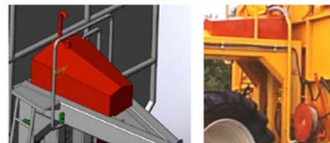
Противопожарное оборудование интегрировано в конструкцию
