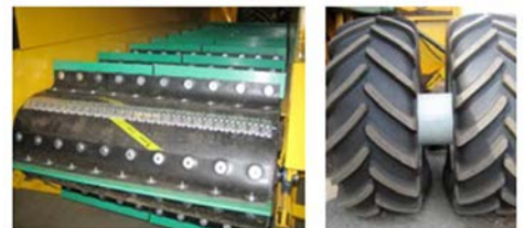
Шипы нагрузочного ремня гибко подсоединены к транспортерной ленте.
